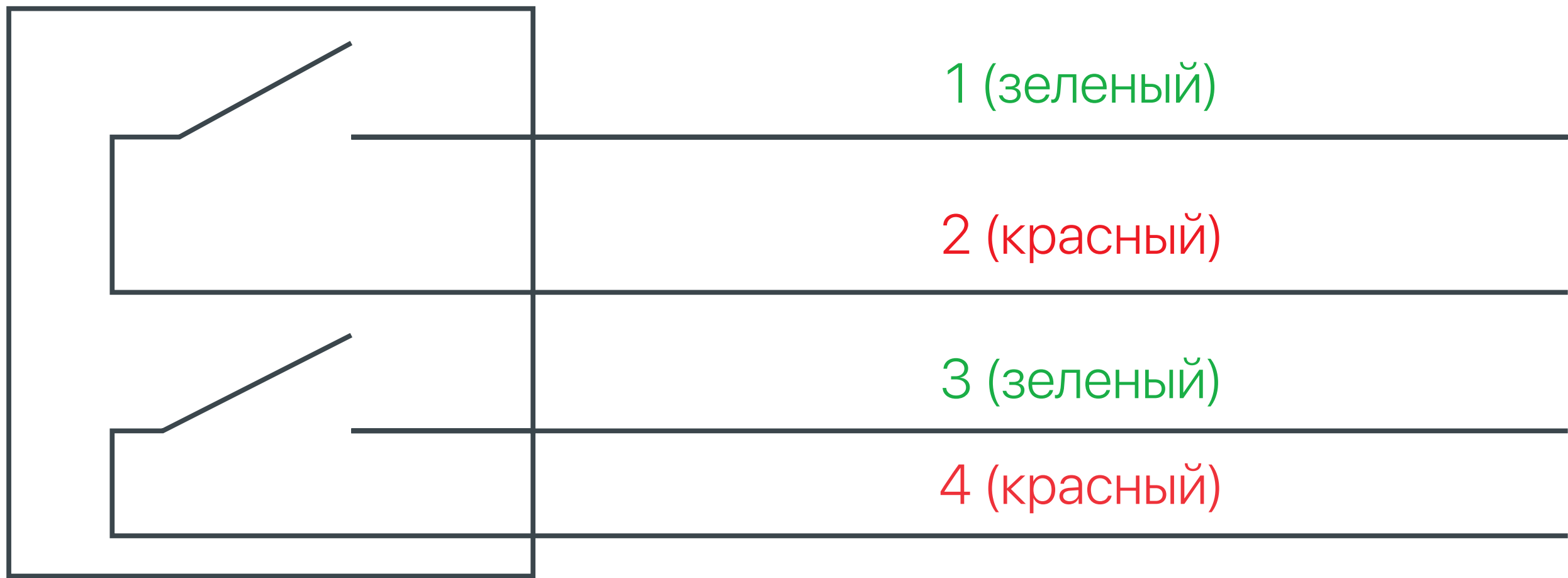
Рисунок 2. Схема подключения сигнализатора давления.
